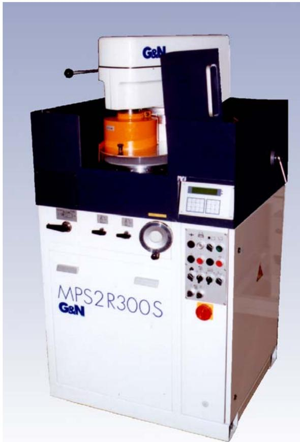
Eine Variante der MPS 2 R 300, speziell angepaßt für das Schleifen schwieriger Materialien wie Werkstoffe für die Elektronikindustrie.
